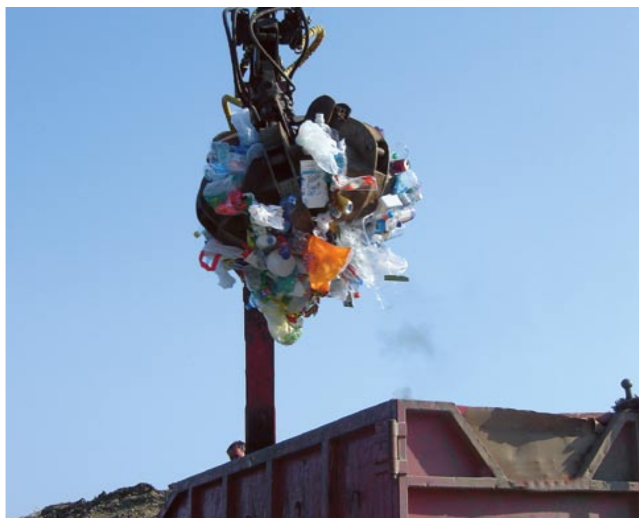
Z ekoloških otokov odpadno embalažo poberejo s posebnimi vozili, nato pa jih v zbirnem centru preložijo v druge zabojnike (na fotografiji). V njih gre 40 kubičnih metrov odpadkov, ko so polni, pa jih odpeljejo k prevzemniku.
